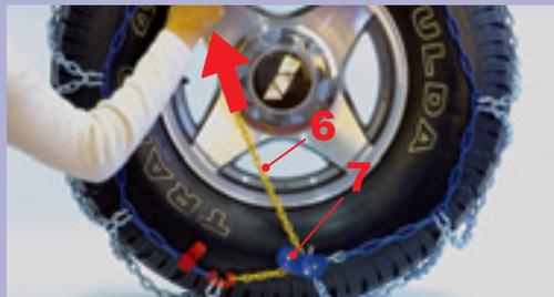
**IT** Tendete la catenella di tensione (6) tirandola verso l'alto. Il dispositivo autobloccante (7) garantirà il mantenimento della tensione.
