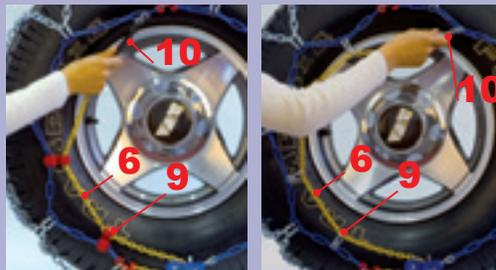
**IT** Agganciate il dispositivo di tensionamento (10) ad una maglia della catena laterale, verificando che la catena di tensione (6) sia ben tesa e facendo, se necessario, uso dei ganci di rinvio (9).
