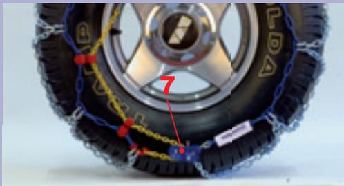
**IT** Arrestate la vettura facendo in modo che il dispositivo di bloccaggio (7) si trovi in basso come illustrato in figura.
